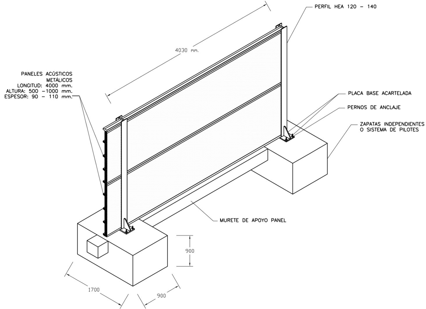
NOTA : CONFIGURACIÓN TÍPICA DE PANTALLA TIPO STOPSON CERRAMIENTO METÁLICO 2m ALTURA:
